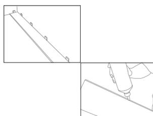
2• Débuter la pose dans un angle, rainure contre le mur. Encoller soigneusement le bord supérieur des languettes sur toute leur longueur avec une colle vinylique aqueuse (ex : Presto BIB).
