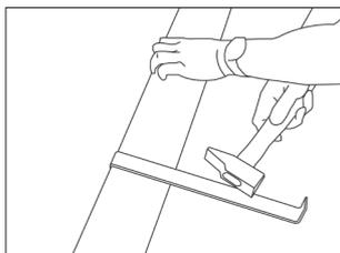
5• Découper les lames de la dernière rangée à la largeur désirée sans oublier l'espace nécessaire au jeu de dilatation. Emboîter les lames à plat avec une chasse métallique.
